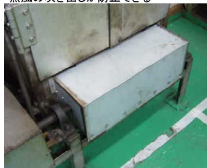
図 10-9 乾燥炉の熱風吹きだし防止
