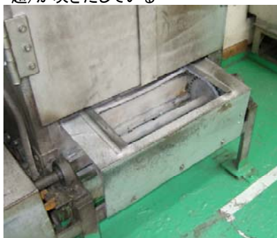
図 10-9 乾燥炉の熱風吹きだし防止
