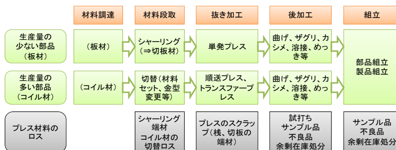
図 16.1 部品の加工工程の例
