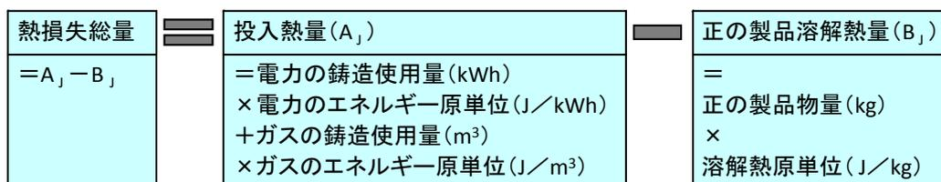
図 3-1 今回の MFCA 導入実証事業における熱損失の総量計算の考え方
