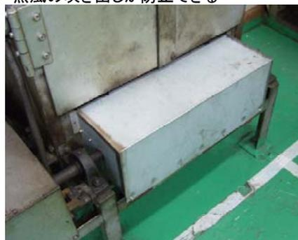
図 10-9 乾燥炉の熱風吹きだし防止
