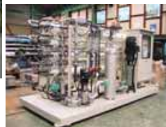
逆浸透膜(ROメンブレンフィルタ)を利用した工場排水のリサイクル装置
