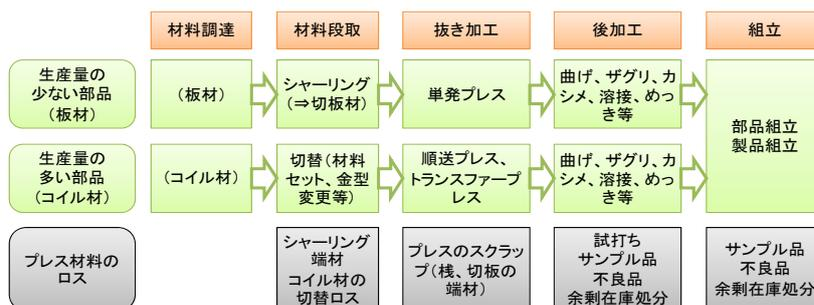
図 16.1 部品の加工工程の例
